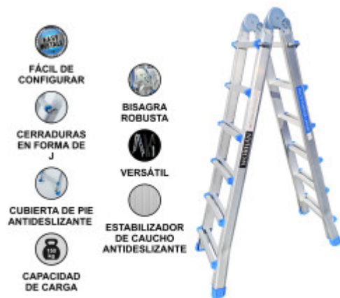
Escalera Aluminio Telescopica 5.87 m Multifuncion Multiuso Aluminio Plegable Tijera. Escalera plegada (163 cm x 48 cm x 20 cm). Carga de trabajo segura - 150 kg. Número de peldaños : 2 x 10, Distancia entre peldaños - 28 cm. Peso - 14.5 kg.
